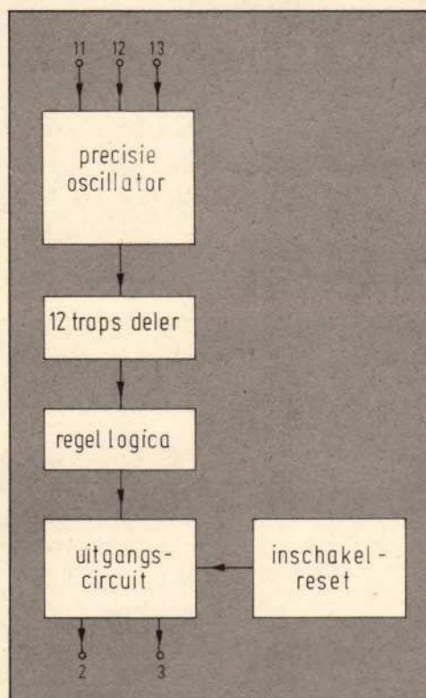
Fig. 1. De Ferranti timer ZN1034E bestaat in hoofdzaak uit een precisie-oscillator, die wordt gevolgd door een 12-traps deler. De looptijd wordt bepaald door de frequentie van de precisie-oscillator in te stellen.
